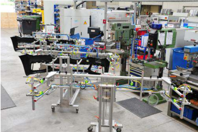
Greifer für Stoßfänger EOAT for Car Bumper
