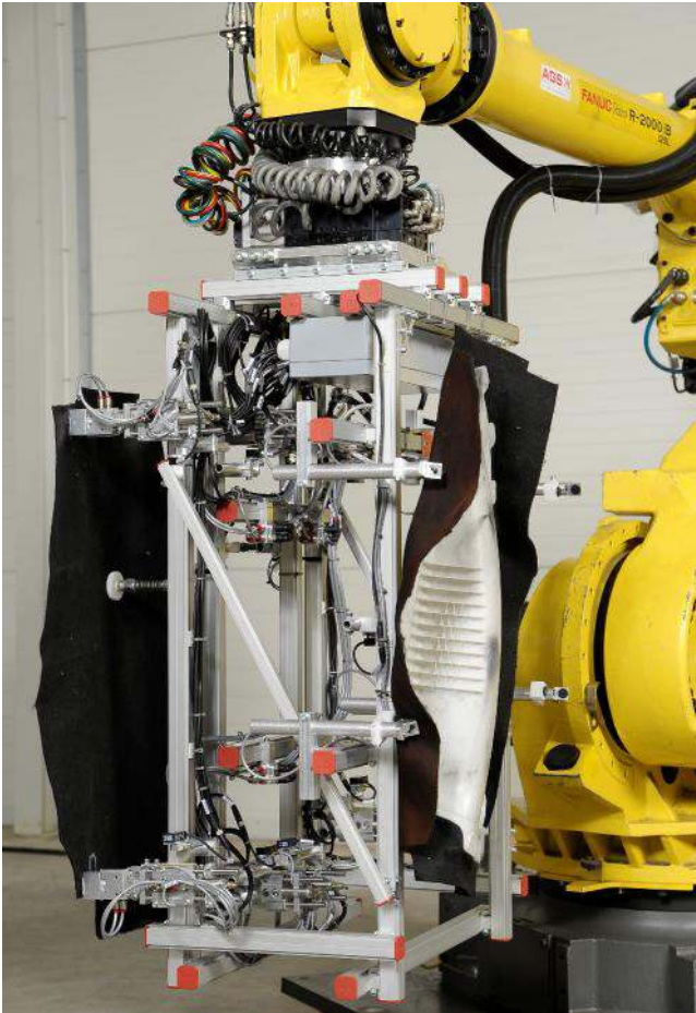
Stoff einlegen - Fertigteilentnahmen Textil insert - Finished Parts removal
