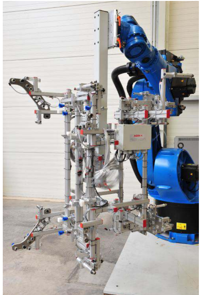
Greifer für Front End / EOAT for Front End
